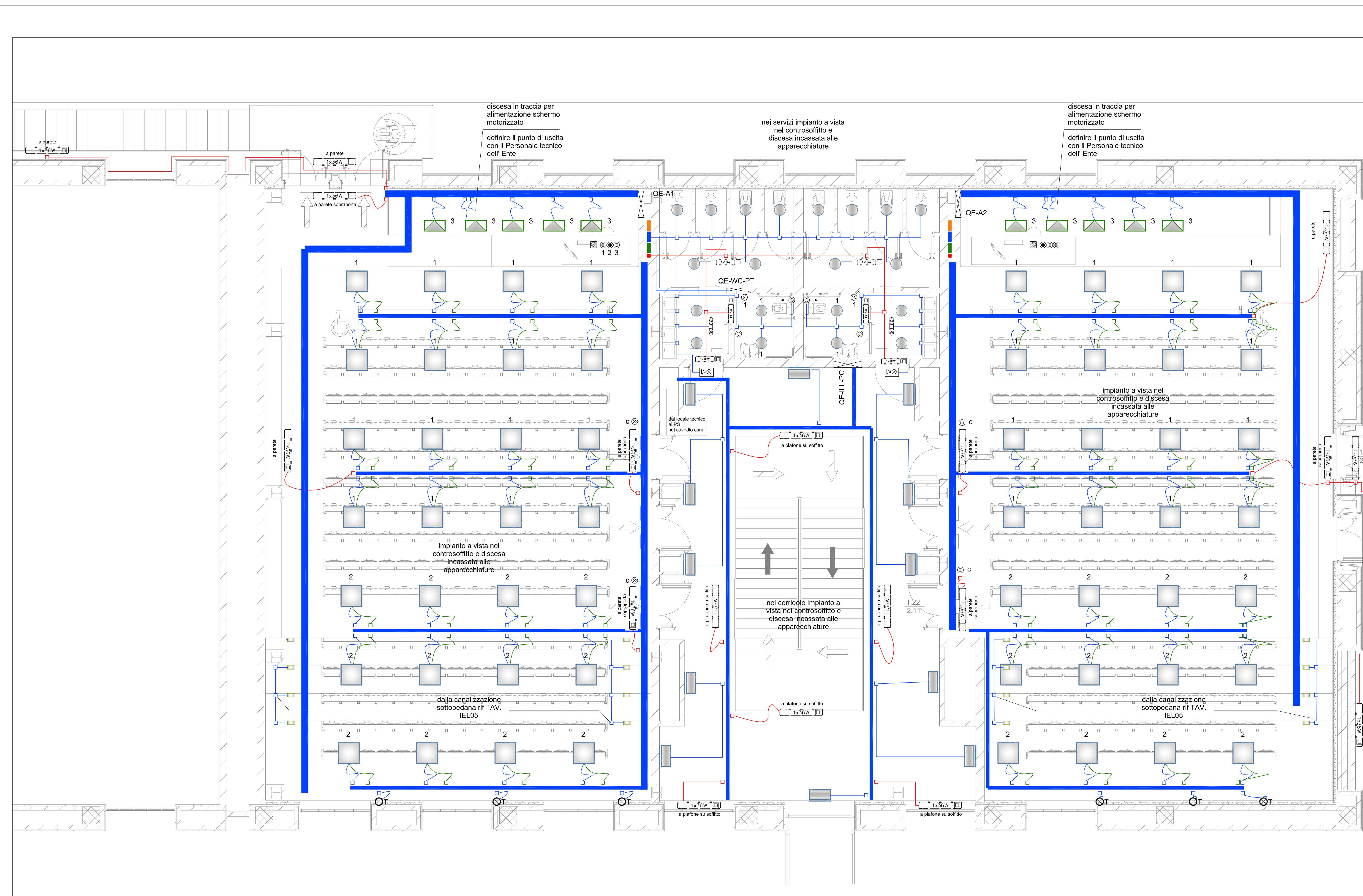
Planimetria impianti di illuminazione illuminazione di sicurezza
